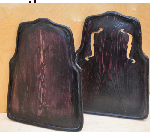
Задняя и резонансная деки фигурного моринхуура. Ель сибирская, тонирование, цвет эбеновый «черное дерево»
